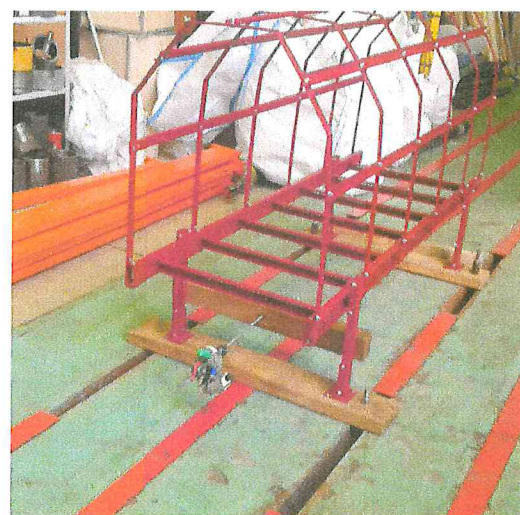
Фото 3. Испытание балок лестницы
