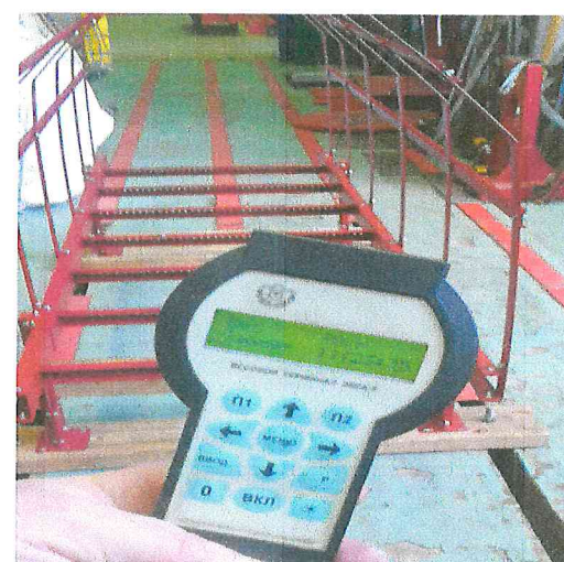
Фото 3. Испытание балок лестницы
