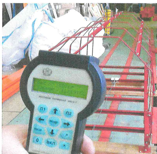
Фото 2. Испытание ступени лестницы
